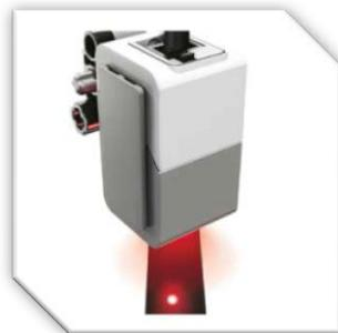
En **mode Intensité de la lumière réfléchie**, le capteur mesure l'intensité de la lumière réfléchie en émettant une lumière rouge. Le capteur utilise une échelle allant de 0 (très sombre) à 100 (très clair). Autrement dit, vous pouvez programmer votre robot pour qu'il se déplace sur une surface blanche jusqu'à ce qu'il détecte une ligne noire ou pour qu'il interprète une carte d'identification avec un code de couleur.
