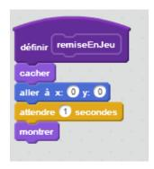
La fonction remiseEnJeu se définit par les actions suivantes : le palet se cache, va au centre de la scène (X=0 ; Y=0), attend une seconde et se montre.
